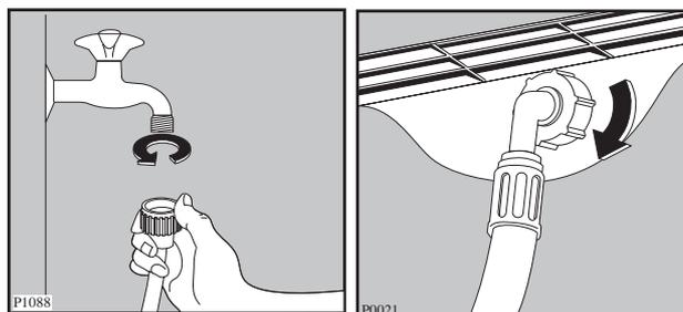
Другой конец наливного шланга, подключающийся к машине, может быть повернут в любом направлении. Ослабьте гайку, поверните шланг и вновь затяните гайку, проверив отсутствие течей воды. Наливной шланг нельзя вытягивать. Если он слишком короткий, и вы не хотите передвигать кран, то вам следует купить новый, более длинный шланг, специально предназначенный для данных целей.
